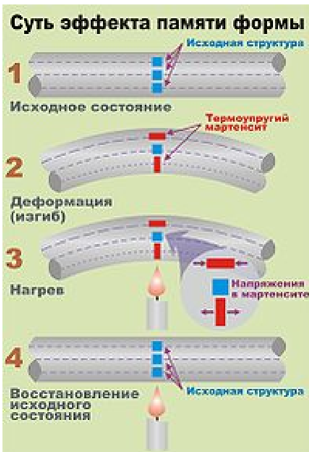
Рис. П. 4. Физическая уцность эффекта памяти формы
