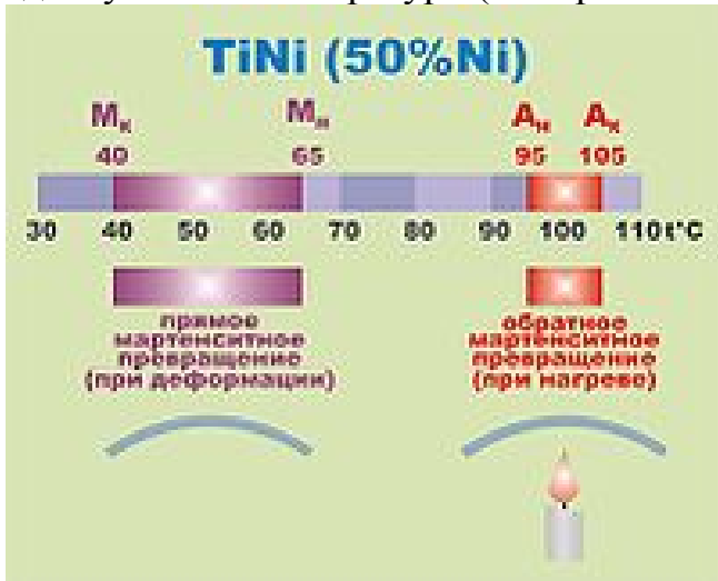
Рис. П. 5. Прямое и обратное мартенситное превращение для сплава TiNi(50%)
