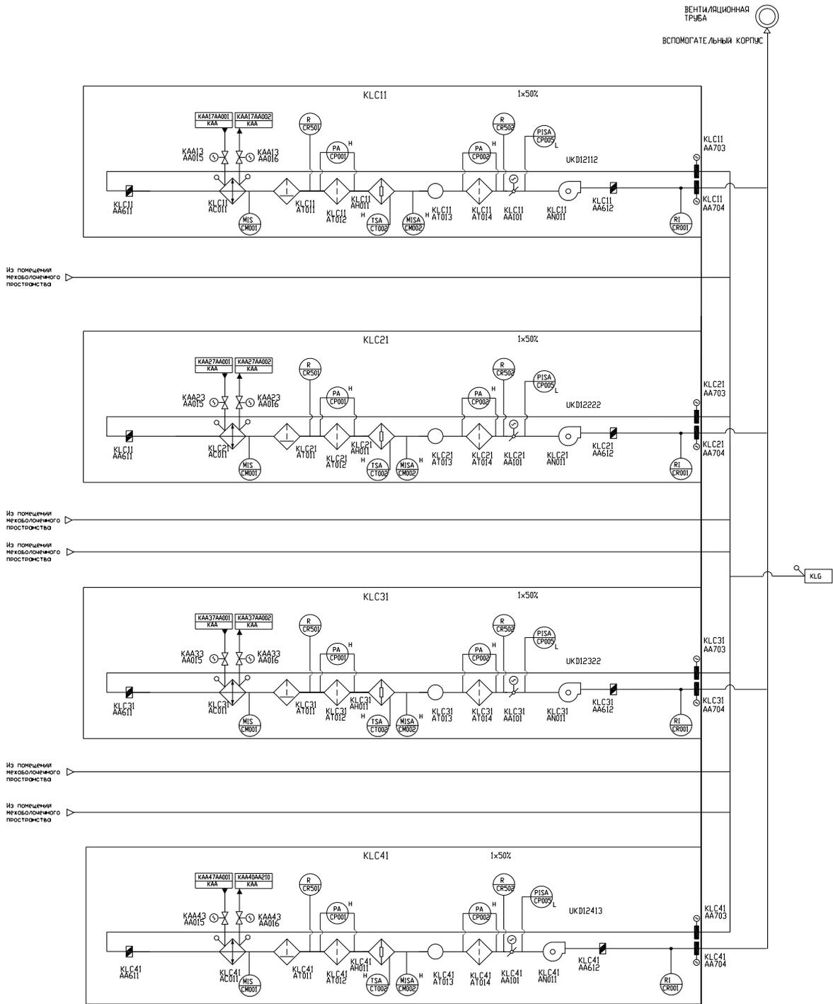
Рисунок 12.2.3.6- Принципиальная схема системы локализации утечек из защитной оболочки KLC11/21/31/41
