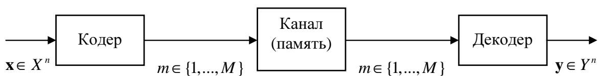
Рис. 4.2: Схема кодирования с заданным критерием качества
